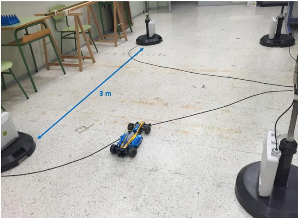
*Esquema del setup para medida de velocidad empleando RFID.*
